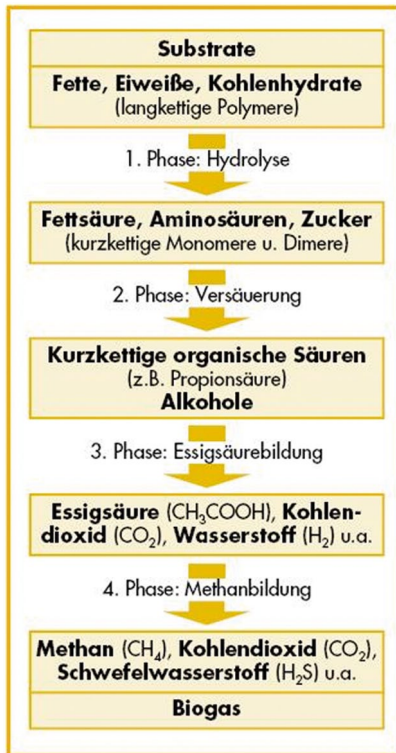
Abb.1.: Vereinfachte Darstellung des Abbaus organischer Biomasse bei der Biogasgewinnung
